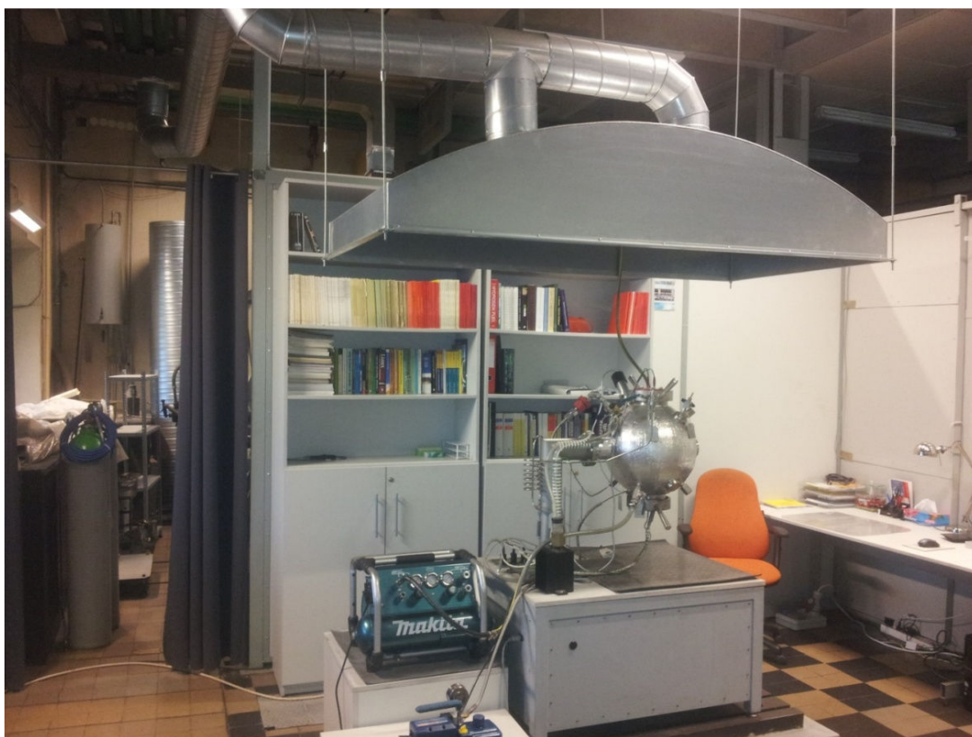
Zdjęcie nr 7 – czynne stanowisko badań granic wybuchowości z czynną wentylacją wyciągową
