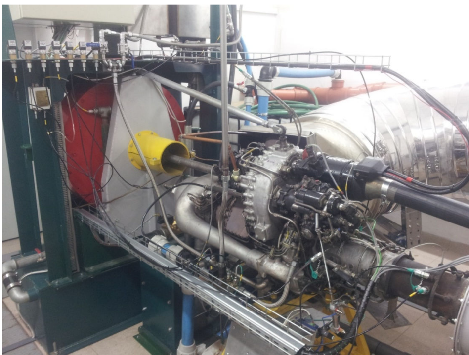
Zdjęcie nr 5 – silnik śmigłowy GTD-350 wraz z hamulcem elektrowirowym, na drugim planie fragment komina spalinowego
