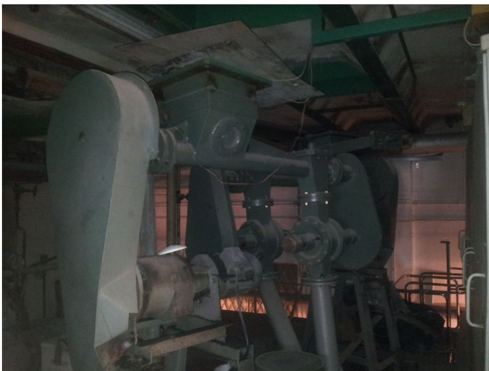
Zdjęcie nr 14 – pozostałości instalacji pieca fluidalnego z ciśnieniową komorą spalania, podajnik ślimakowy do paleniska
