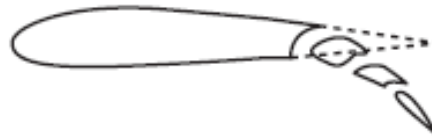
Kłapa trój-szczelinowa (ang. triple-slotted flap)
