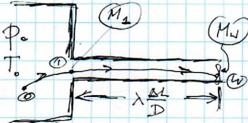
W przekroju wylotowym  $P_w = P_0$  dla  $M_w < 1$
