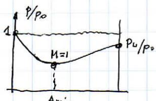
Liczba Macha w przekroju wyłotowym jest mniejsza od jednostki. Jej wartości wynika ze wzoru  $\frac{A_U}{A_*} = F(M)$  dla podobieństwa gęstości powietrza ...
